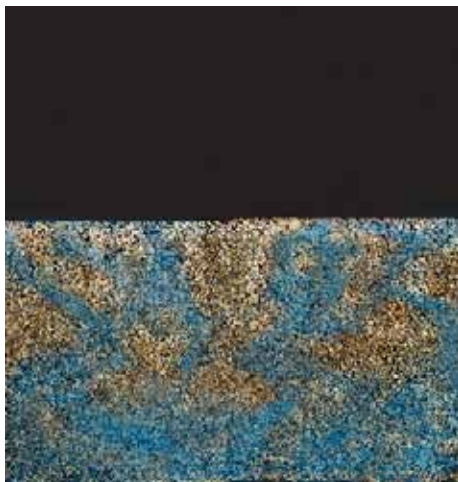
砂土ベースの根域の選択流を示す図
