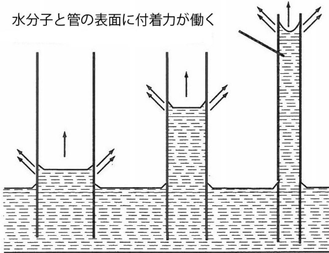
付着力によって重力に反して上に向かって水が移動する
